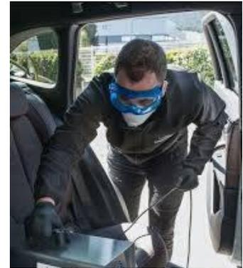
Utilisation dans les véhicules avec une machine à ozone autonome (aspire l'oxygène et expulse du trioxygène)
